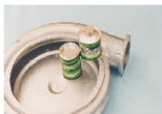
sửa chữa các lỗ khí trên vỏ bơm
