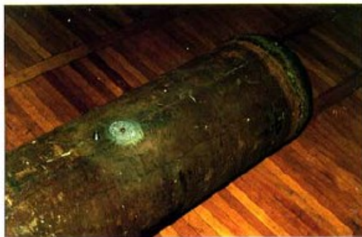
Mẫu đường kính lớn với khuyết tật "lỗ tròn" trước và sau khi sửa chữa
