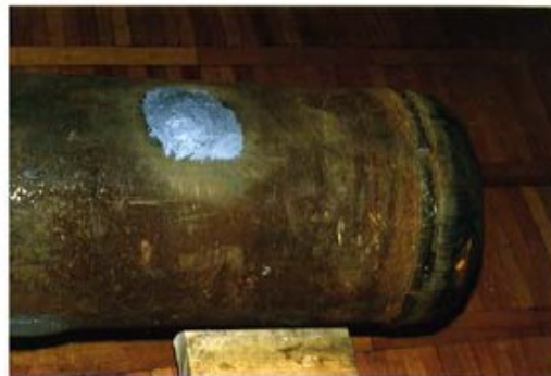
Mẫu đường kính lớn với khuyết tật "lỗ tròn" trước và sau khi sửa chữa
