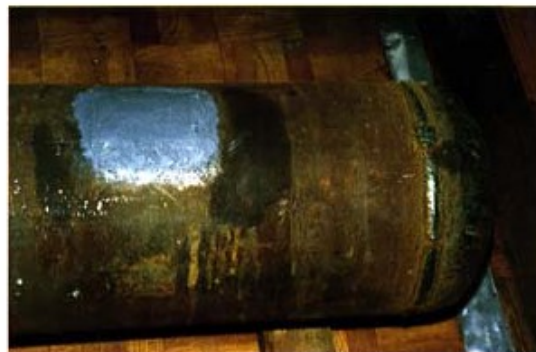
Mẫu đường kính lớn với khuyết tật "nhiều vết nứt" trước và sau khi sửa chữa
