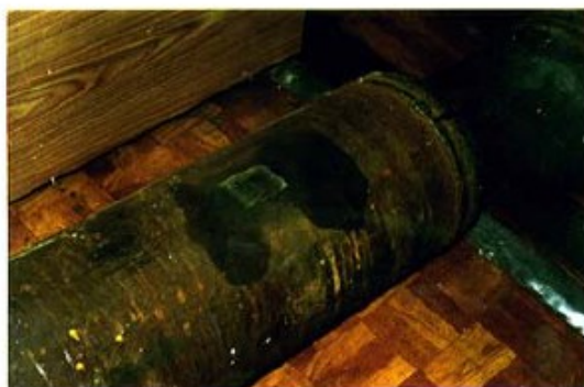
Mẫu đường kính lớn với khuyết tật "nhiều vết nứt" trước và sau khi sửa chữa
